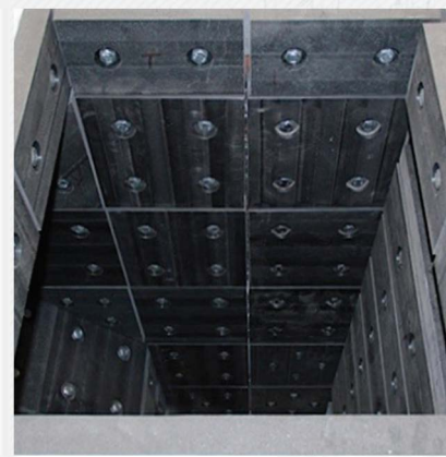
Абразивостойкая стальная или полимерная футеровка
