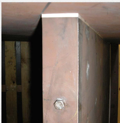
Заменяемые уплотнения заслонки уменьшают пыление
