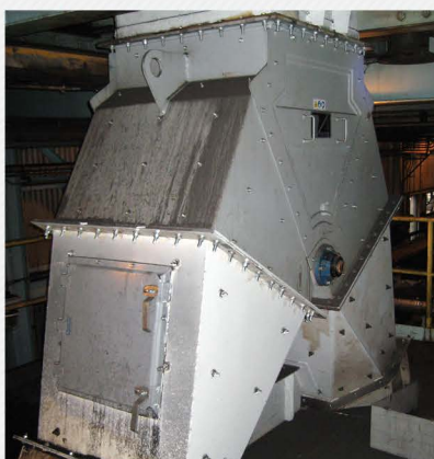
Дивертер 56" (1422 мм) работает с углем
