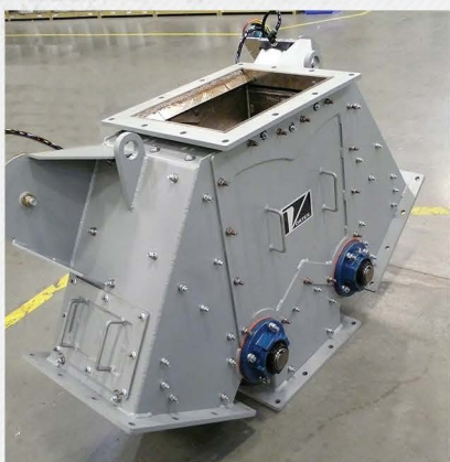
Дивертер 309 мм x 457 мм работает с кварцевым песком
