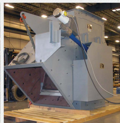
Дивертер 62" (1575 мм) работает с стеклобоем
