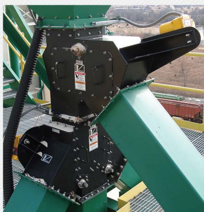
16" (406mm) straight line Aggregate Diverter работает с песком
