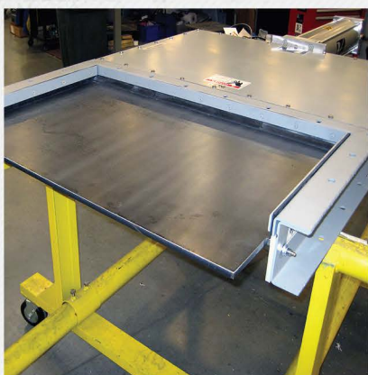
Задвижки 610 мм x 965 мм установлена в системе вибропитателя для дозирования потока угля
