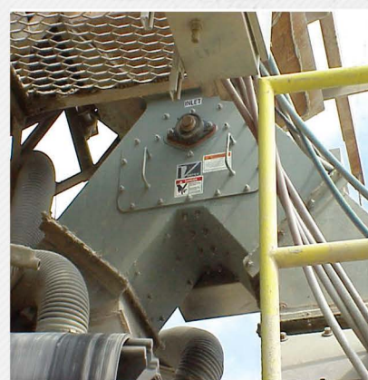
14" (356mm) Aggregate Diverter работает с гравием и песком
