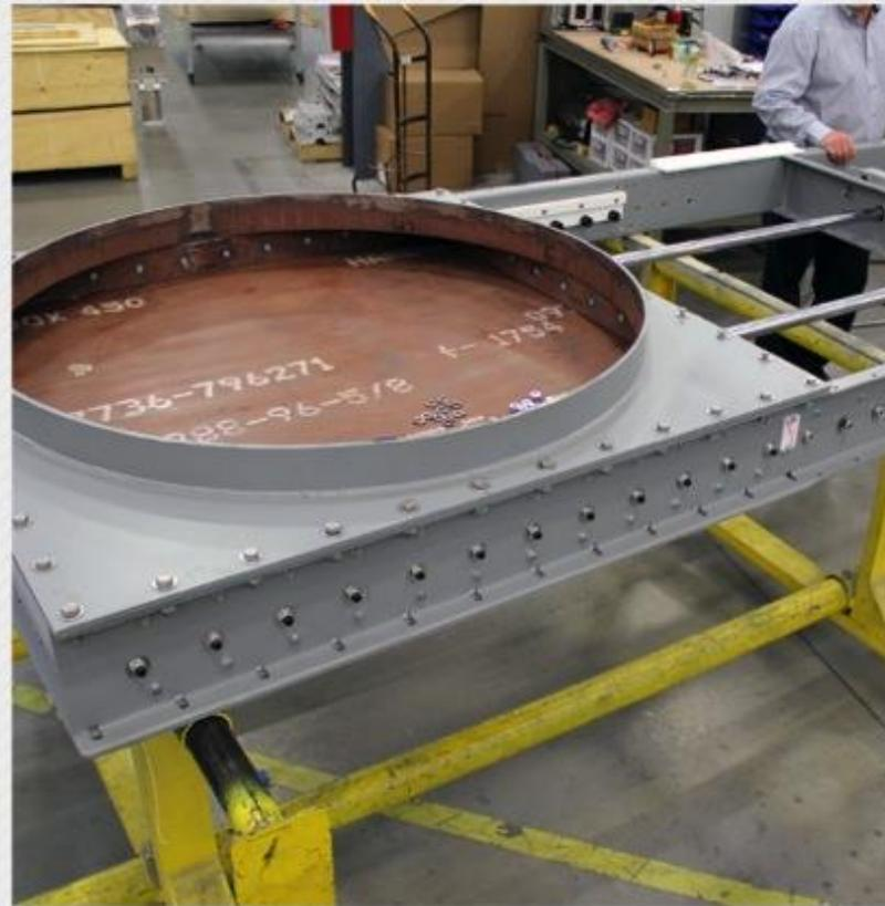
Задвижка 48" (1219мм) работает с бентонитом
