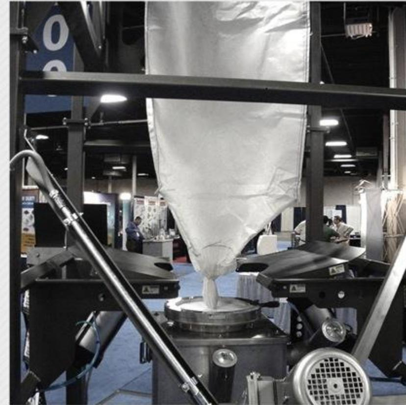
Задвижка 15" (381мм) работает на разгрузке биг-бэга
