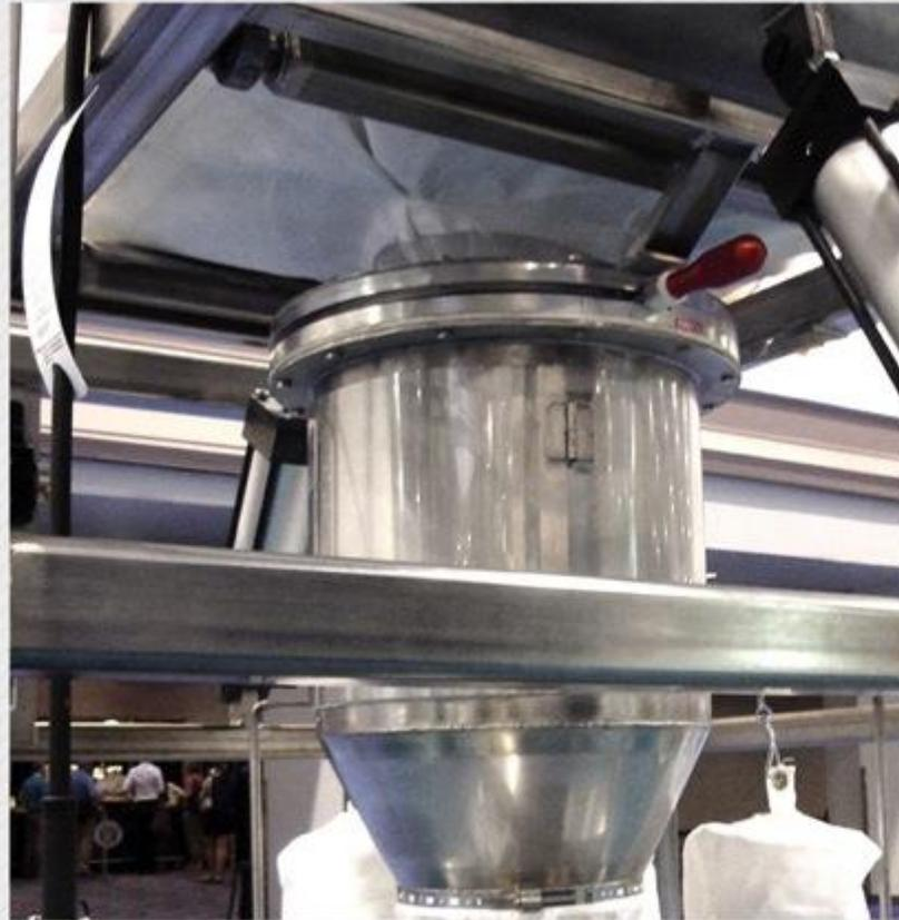
Задвижка 18" (457мм) работает на разгрузке биг-бэга
