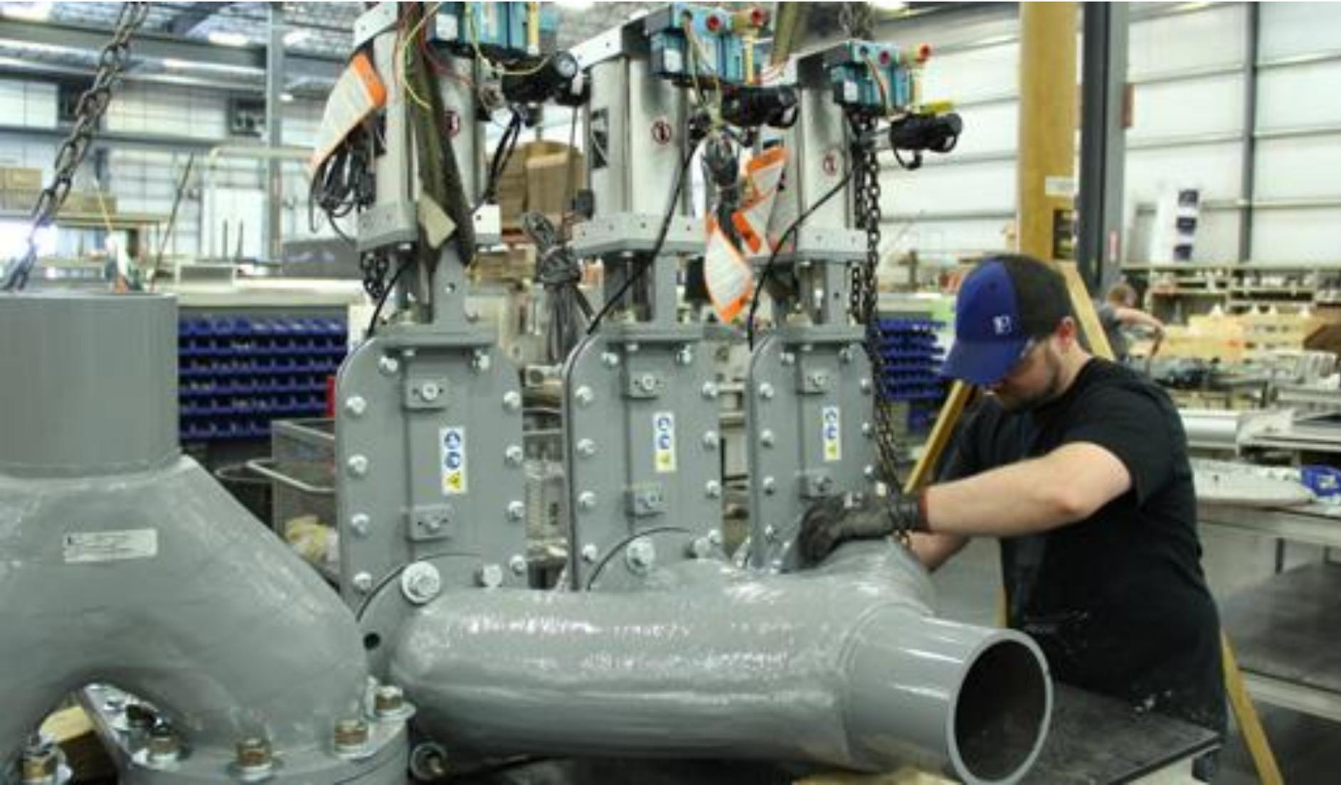
150мм задвижки и 3-ходовой основной дивертер работают с галечной известью на сталелитейном заводе
